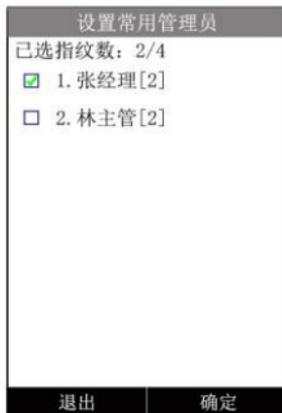
**c 更换常用操作员**，从预设的 225 枚指纹中设置 16 枚常用操作员指纹（每个人最多绑定 3 枚指纹，具体数量按需要设置）
