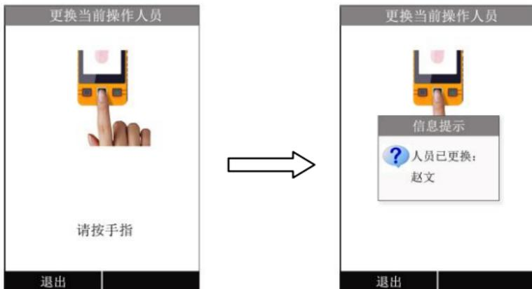
**b 更换常用管理员**，从预设的 225 枚指纹中设置 4 枚常用管理员指纹（每个人最多绑定 3 枚指纹，具体数量按需要设置）
