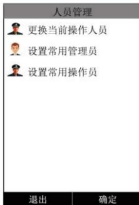
a **更换当前操作人员**，巡检员巡检前录入指纹更换操作员，更换成功屏幕会提示“人员已更换”并显示更换的巡检员姓名。长时间不按指纹，会显示“无此指纹信息”，同时机器振动 3 次，返回主界面，如果录入非绑定人员指纹，屏幕显示“无此指纹信息”，机器振动 3 次，当第三次指纹录入还不成功时，系统会提示“次数超限”，这时需返回上一界面，重新按键进入指纹更换界面。
