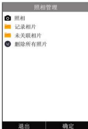
**a 拍照。** 点击“确定”或是按“操作”右键进入拍照界面，系统可以自动聚焦，确定画面后点击中间的“相机”图标拍照，点击“保存”拍照完成。点击“退出”后可重新拍摄。
