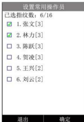
**7. 指纹管理。**在此界面可以注册管理员、操作员指纹，删除指纹，查询编号。本仪器有 20 枚和 150 枚两种指纹存储量可选择。如果机器已经录入管理员信息，进入此操作屏幕会显示“**请按管理员手指**”（录入管理员指纹信息后，进行指纹管理都需要验证管理员指纹）。如果是新机器，则直接进入操作界面，如下：
